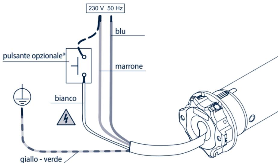
\* L'installazione del pulsante è opzionale, il collegamento può essere eseguito con la fase (filo marrone) o con il neutro (filo blu), indifferente. Con il pulsante è possibile comandare il motore in modalità passo passo (salita, stop, discesa, stop ...).
