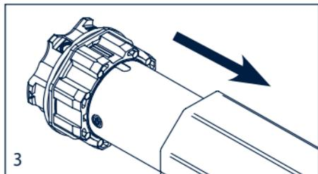
3. Introdurre completamente il motore nel tubo di avvolgimento.
