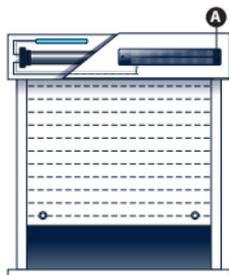
Per l'ancoraggio del pannello, si possono impiegare 2 rivetti o viti. Di seguito sono riportati i passaggi procedurali:
