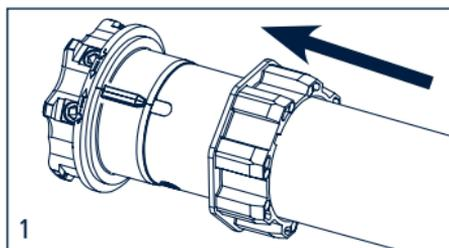
1. Inserire l'adattatore sulla ghiera finecorsa facendo combaciare la scanalatura con la tacca di riferimento e spingere fino alla battuta.
