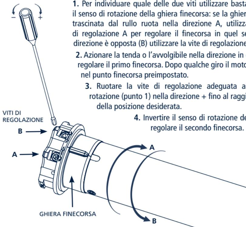
1. Per individuare quale delle due viti utilizzare basta osservare il senso di rotazione della ghiera finecorsa: se la ghiera finecorsa trascinata dal rullo ruota nella direzione A, utilizzare la vite di regolazione A per regolare il finecorsa in quel senso. Se la direzione è opposta (B) utilizzare la vite di regolazione B.
