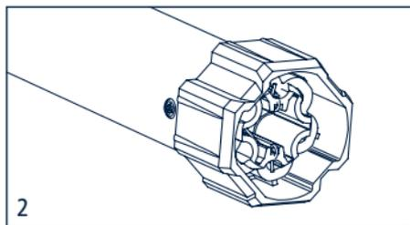
2. Montare la puleggia di traino sul perno del motore fino allo scatto della molla di fermo.
